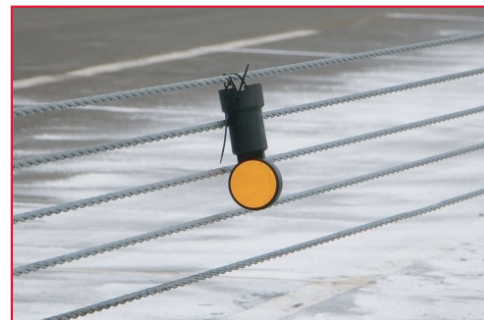
●試験車両衝突後のゴム製視線誘導標
